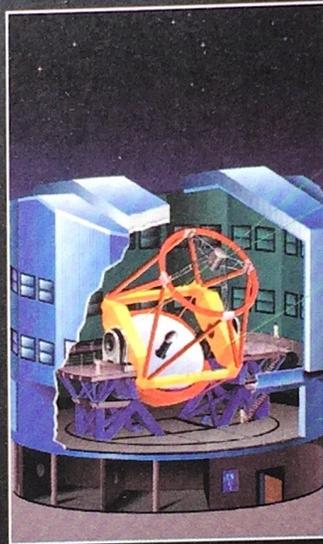
sore di 17 centimetri e pesa 20 tonnellate: è così sottile che è come se si cercasse di fare un telescopio con un pezzo di carta. In realtà dietro allo specchio c'è un supporto, una culla dotata di 150 pistoni. Questi, controllati da un computer, danno la giusta forma alla superficie, adattandola in tempo reale alle perturbazioni dell'atmosfera».
